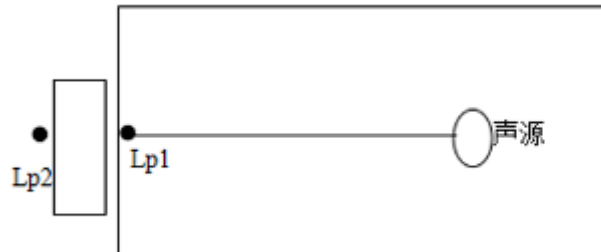
图 4-3 室内声源等效为室外声源图例
